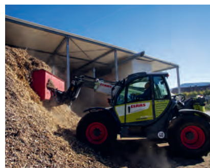
Der Radlader transportiert Hackschnitzel ins Heizwerk und sorgt für Nachschub.
